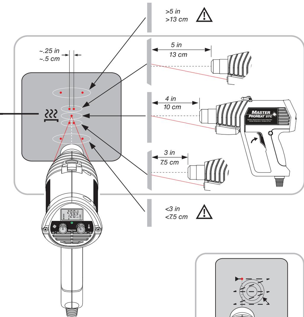
**HINWEIS:** Die Zielflächentemperatur der ProHeat STC kann in Schritten von 10 Grad auf bis zu 260 °C (500 °F) eingestellt werden. Wärmeleitfähigkeit, Emissionsvermögen und Wetterbedingungen können den maximalen Wärmebereich beeinflussen. Die Oberflächen verschiedener Materialien haben eine unterschiedliche Wärmeabsorptionsfähigkeit. Es liegt in der Verantwortung des Benutzers, die Eignung des Produkts für die jeweilige Anwendung zu beurteilen.
