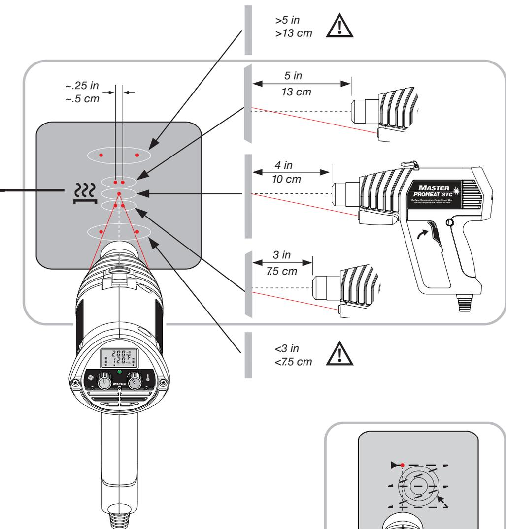
**REMARQUE :** Le pistolet ProHeat STC accepte des températures de surface cible allant jusqu'à 260 °C (500 °F) par incréments de 10 degrés. La conductivité thermique, l'émissivité et les conditions climatiques peuvent jouer sur la plage de température maximale. Différents matériaux de surface ont des capacités d'absorption thermiques variables. Les utilisateurs devront évaluer de façon indépendante l'adéquation du produit par rapport à leur utilisation.
